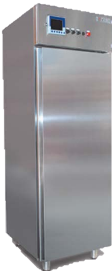
Figura 5. Ambiente di prova condizionato (armadio climatico).
